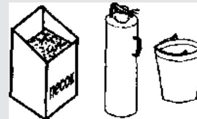
Обустройство рабочего места для газопламенных работ
