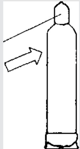
— произвести внешний осмотр баллона, убедиться в отсутствии механических повреждений на корпусе баллона, на кислородном баллоне не должно быть следов масла;
